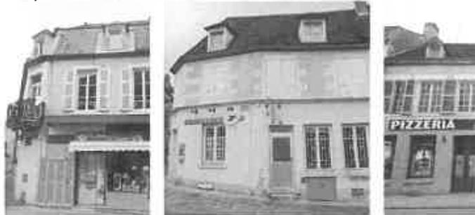
Exemple de façade enduite avec pierres apparentes en encadrement de baies et chaînage d'angle
